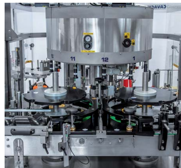
Stella multiformato Adjustable multi-format starwheels Etoile multiformat Estrella multiformato Mehrformat-Stern
