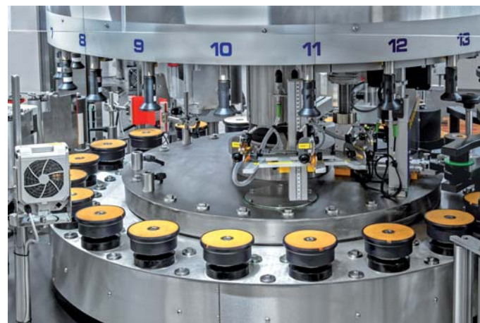
Orientamento ottico (disponibile a fotocellula o a fibra ottica) Optical orientation to capsule or bottle (using photocells or fiberoptics) Repérage optique (disponible par photocellule ou fibre optique) Orientación optica (disponible con fotocélula o fibra optica) Optische Ausrichtung (durch Fotozelle oder optische Glasfaser verfügbar)
