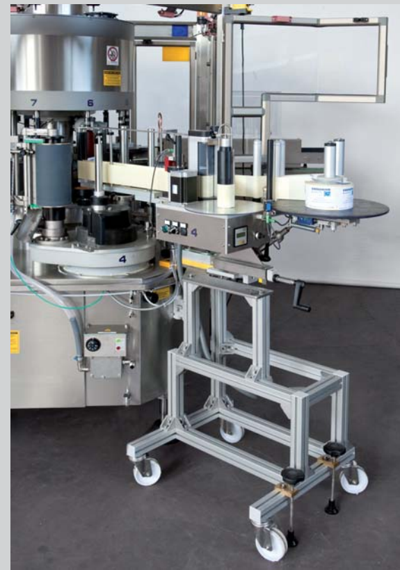
Stazione autoadesiva modulare inserita su stazione a colla Modular pressure sensitive labeling unit combined on a wet glue station Poste d'étiquetage adhésif modulaire intégré sur poste à colle Estación dauo adhesiva modular para integrar en su estación de cola Modulare Selbstklebendestation eingebaut auf einer Leimetikettierstation
